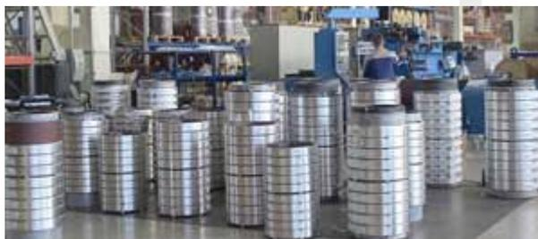
минимизировать потери в стали, снизить уровень шума. Мы применяем самое современное оборудования для резки и укладки сердечников, которое позволяет получить максимальную эффективность использования материала и надежность готовых изделий.
