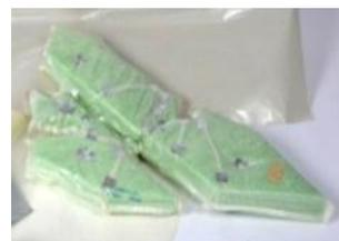
Изоляционное покрытие для верхней части фюзеляжа
