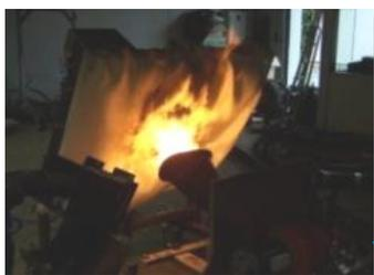
Огнестойкое покрытие для нижней части фюзеляжа
