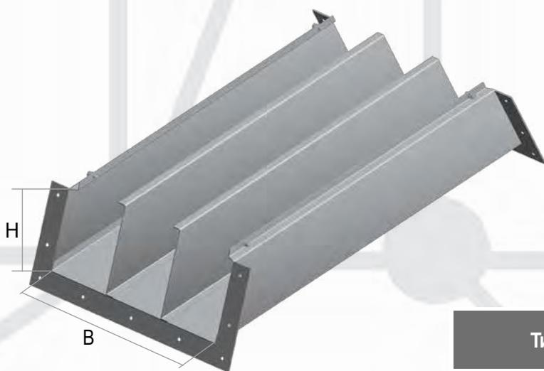
Короб кабельный блочный трехканальный применяется поворота кабельной трассы на 45 градусов вверх в вертикальной плоскости с внутренним углом поворота. Три канала короба разделены перегородками, что позволяет смонтировать три не соприкасающиеся параллельные трассы.
