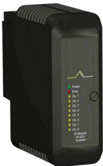
Плата традиционного ввода/вывода легко устанавливается на несущую панель ввода/вывода
